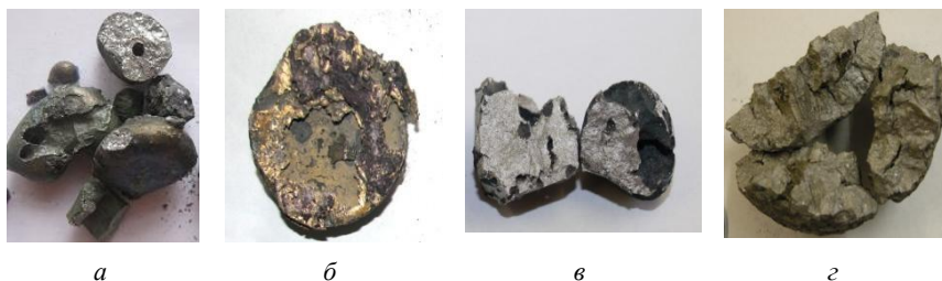
a – хром-молибден; б – медь-хром; в – медь-марганец; г – железо-молибден
