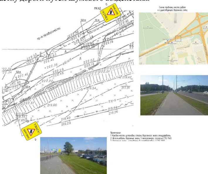
Рисунок 1 – Схема установки дорожных знаков на съезде с проспекта Независимости на МКАД
