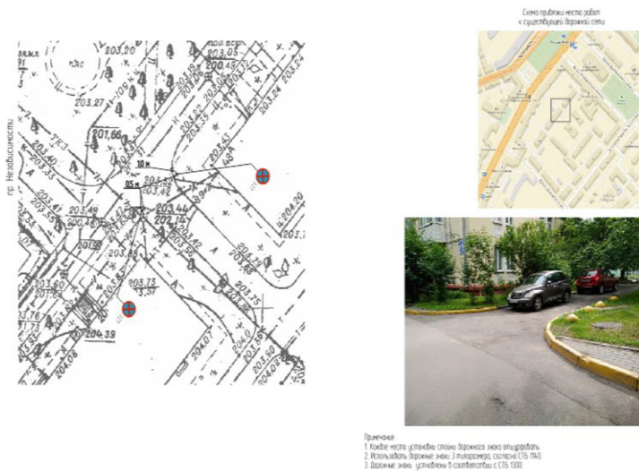
Рисунок 1 – Схема установки дорожных знаков на дворовой территории пр. Независимости, 46а и 48а
