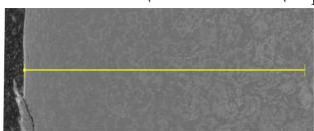
Рис. 1. Структура стали после легирования частицами свинца в режиме сверхглубокого проникания и последующего газового азотирования, \times 10
