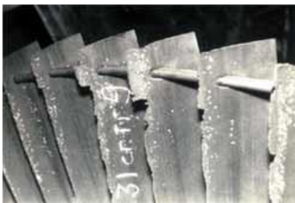
Рисунок 1. Вид эрозионно-разрушенных лопаток
