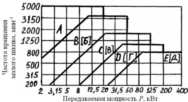
Рис. 9.2. Рекомендуемые сечения ремней
