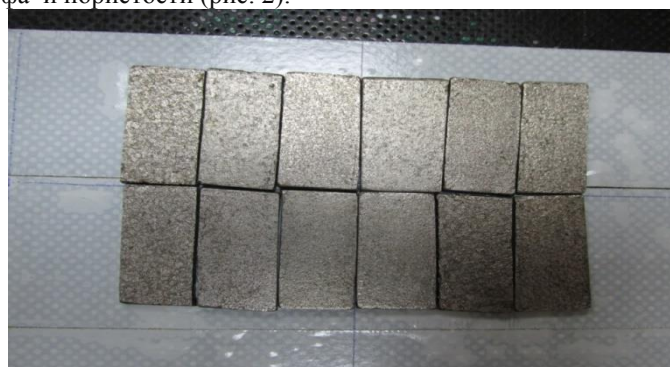
Рисунок 2 – Топография поверхности стальных образцов после их обработки в различных режимах ЭИЛ с УЗВ
