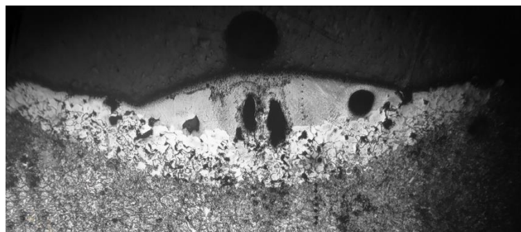
Рисунок 5 - Вид сечения зоны лазерного легирования чугуна СЧ20, полученной при скорости перемещения луча 600 мм/мин, х200
