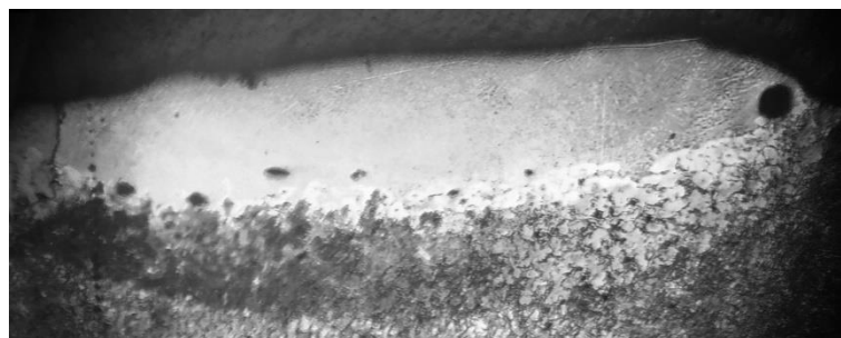
Рисунок 3 – Вид сечения зоны лазерного легирования чугуна СЧ20, полученной при скорости перемещения луча 200 мм/мин, х200
