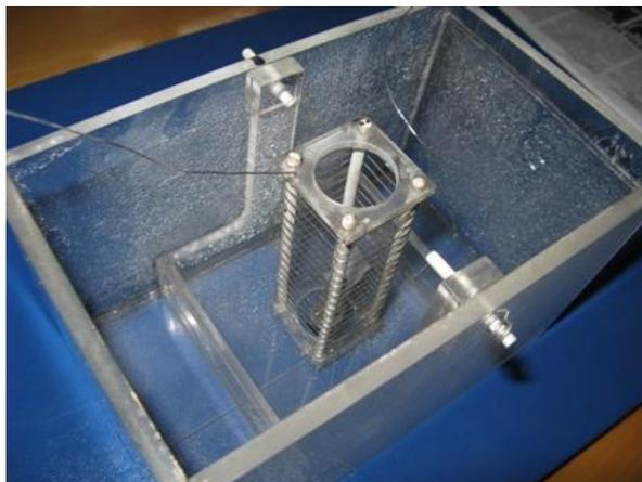
Рисунок 1 - Установка для электролитического насыщения металлических пластин водородом
