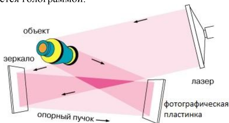
Рисунок 1. Схема регистрации голограмм
