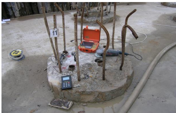
Рис. 1. Оборудование для определения сплошности бетона ствола свай
