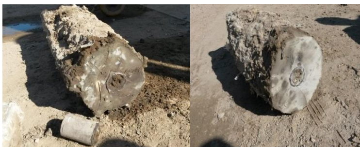
Рис. 6. Слева свая с В:Ц = 1:1,25, Справа свая с В:Ц = 1:1,5
