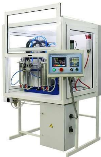
Рисунок 1 – Оборудование для производства вспененных эпоксидных компаундов.
