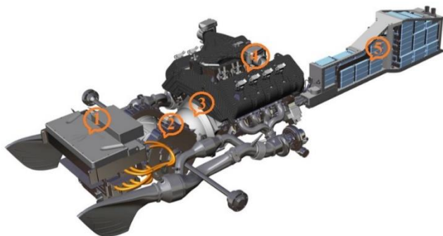
Рисунок 2 – 1) электродвигатель; 2) электромотор; 3) система прямого привода; 4) ДВС; 5) аккумулятор [2]
