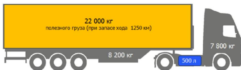
Рисунок 3 – Стандартный европейский автопоезд общей массой 38 т с дизельным двигателем
