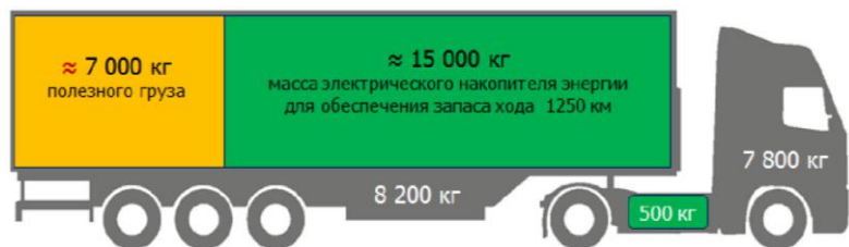
Рисунок 4 – Аналогичный автопоезд общей массой 38 т с чисто электрической силовой установкой и ионно-литиевыми накопителями электроэнергии
