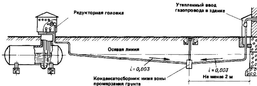
Рис. 4.10. Схема газоснабжения сжиженным газом от резервуарной установки
