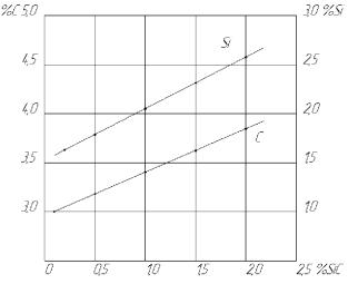
Плавка чугуна осуществляется в вагранке с кислой футеровкой, причем часть ферросилиция заменялась карбидом кремния. Карбид кремния давали в металлозавалку в виде брикетов. При введении возрастающего количества брикетов SiC возрастало содержание углерода и кремния по сравнению с базовым чугуном.
