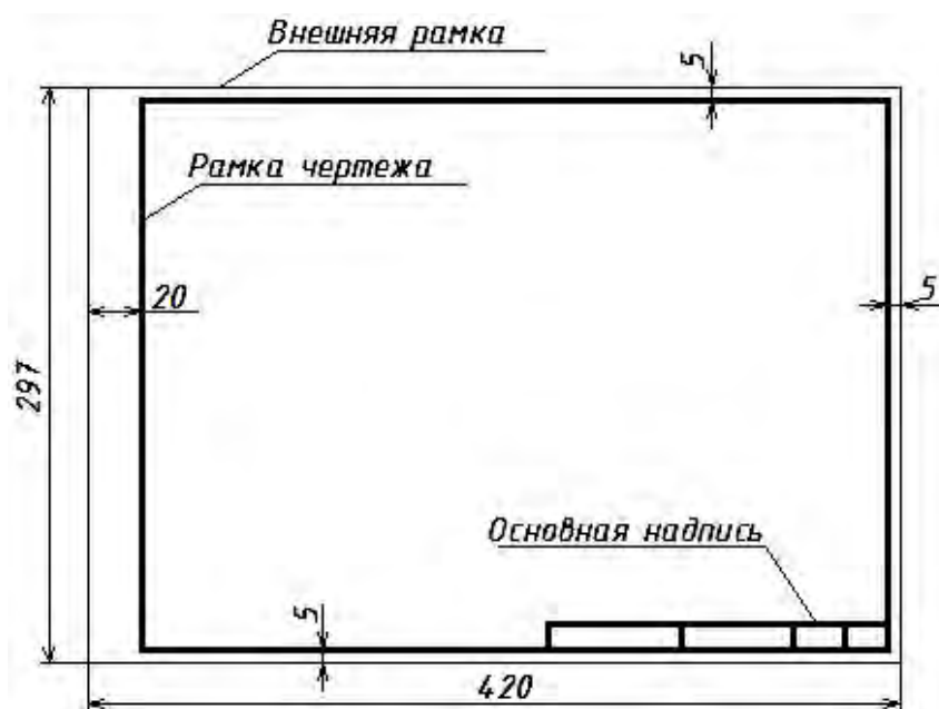
Рис. 1.1. Рамка поля чертежа
