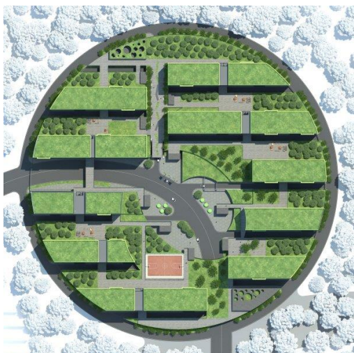
Рисунок 2 - Пример организации транспортного движения в жилом квартале. Архитектурная концепция жилого квартала в Сколково, г. Москва. Жилое пространство располагается на платформе, под которой расположены автостоянки и проходит транспортное сообщение
