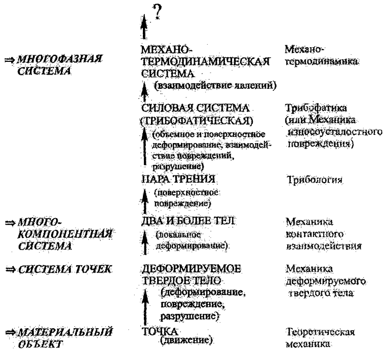
Рисунок 3 – Иерархическая структура некоторых объектов, изучаемых в механике: от простого к сложному
