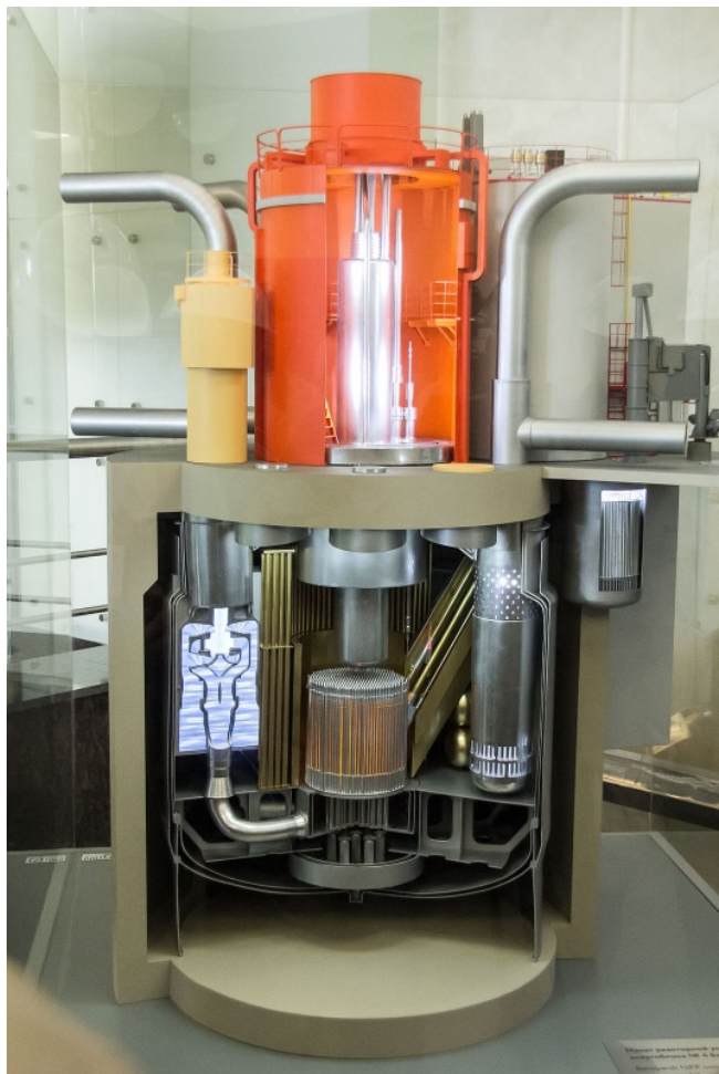
Рисунок 2 – Макет реактора БН-800 (производит больше топлива, чем потребляет)
