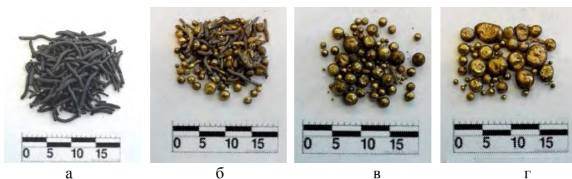
а – внешний вид; б – 850 °С; в – 900 °С; г – 950 °С Рисунок 11 – Спексаемость медных волокон с 50 % Zn
