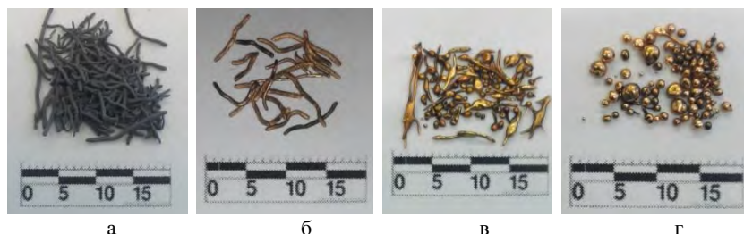
а – внешний вид; б – 850 °С; в – 900 °С; г – 950 °С Рисунок 8 – Спексаемость медных волокон с 30 % Zn
