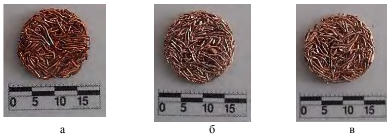
а – 850 °С; б – 900 °С; в – 950 °С Рисунок 4 – Спекаемость исходных медных волокон
