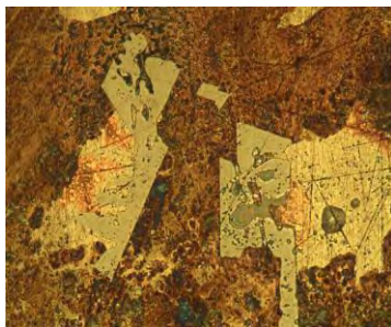
Рисунок 4 – Микроструктура силицида меди, \times 500
