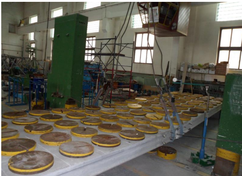
Рис. 8. Диск перекрытия после полной передачи нагрузки
