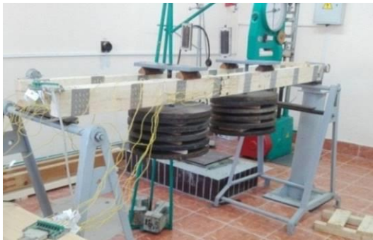
Рис. 2. Схема испытания балок ( a ), общий вид испытательной установки ( б )
