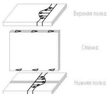
Рис. 3. Неравномерное распределение нормальных напряжений в полке балки в результате сдвигового запаздывания
