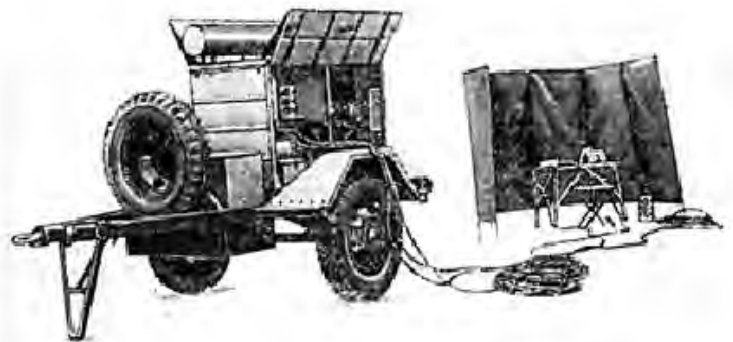
Рисунок 3.7 – Сварочный агрегат в положении для использования
