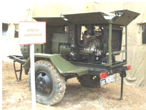
Рисунок 3.6 – Сварочный агрегат на одноосном прицепе
