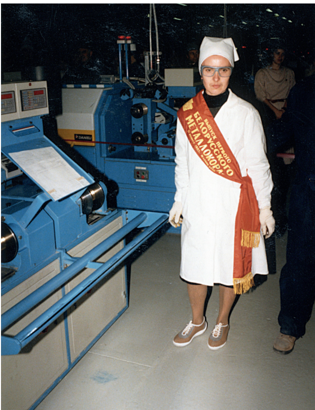
Участница церемонии пуска цеха, машинист по навивке канатов 4-го разряда Юлия Абашкина демонстрирует изготовление прядей 4x0,22
