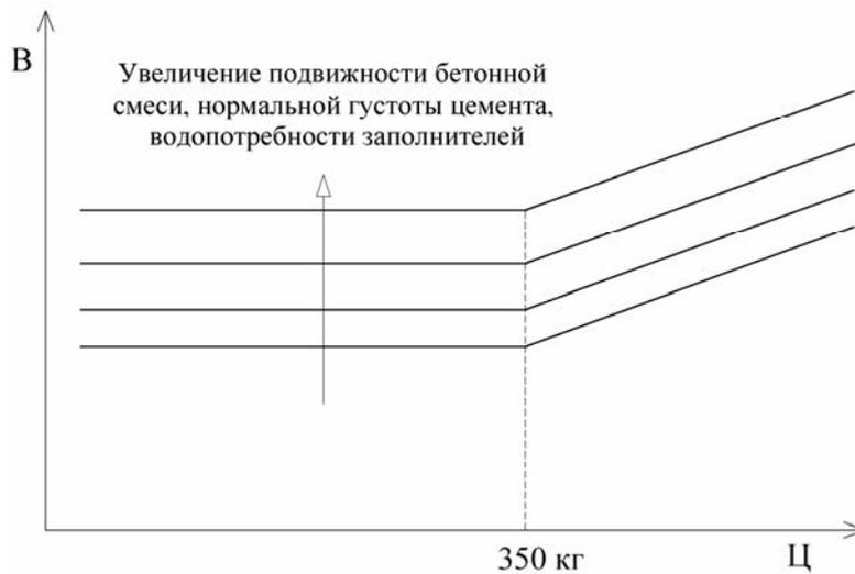
Рис. 2. Зависимость водопотребности бетонной смеси  $V$  от расхода цемента  $Ц$
