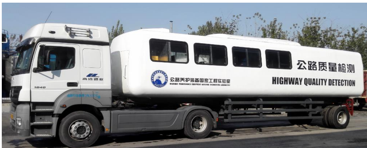
Рисунок 4 – мобильный измерительный комплекс для диагностики дорожных одежд
