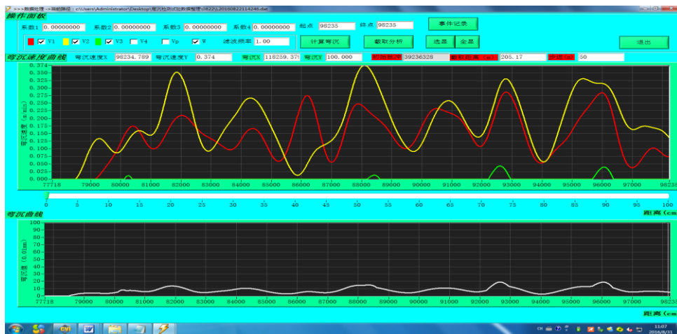
Рисунок 5 – результаты измерения упругого прогиба
