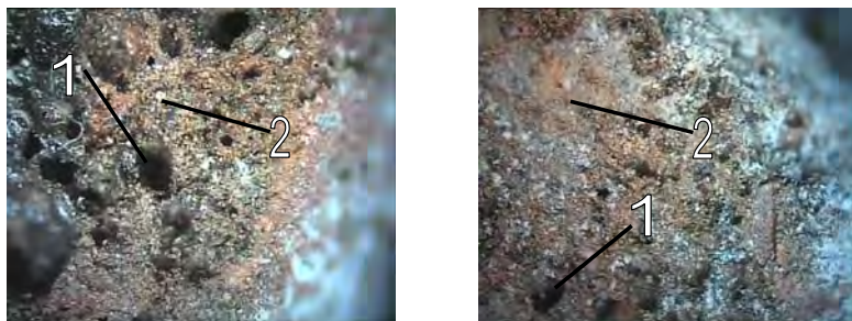
Рис. 7.13. Структура гранул гравия керамзитового насыпной плотностью 600 \text{ кг/м}^3 после испытаний на морозостойкость (увеличение в 65 раз): 1 – открытые поры; 2 – водостойкая пленка, образованная самопроизвольно затвердевшей ГС
