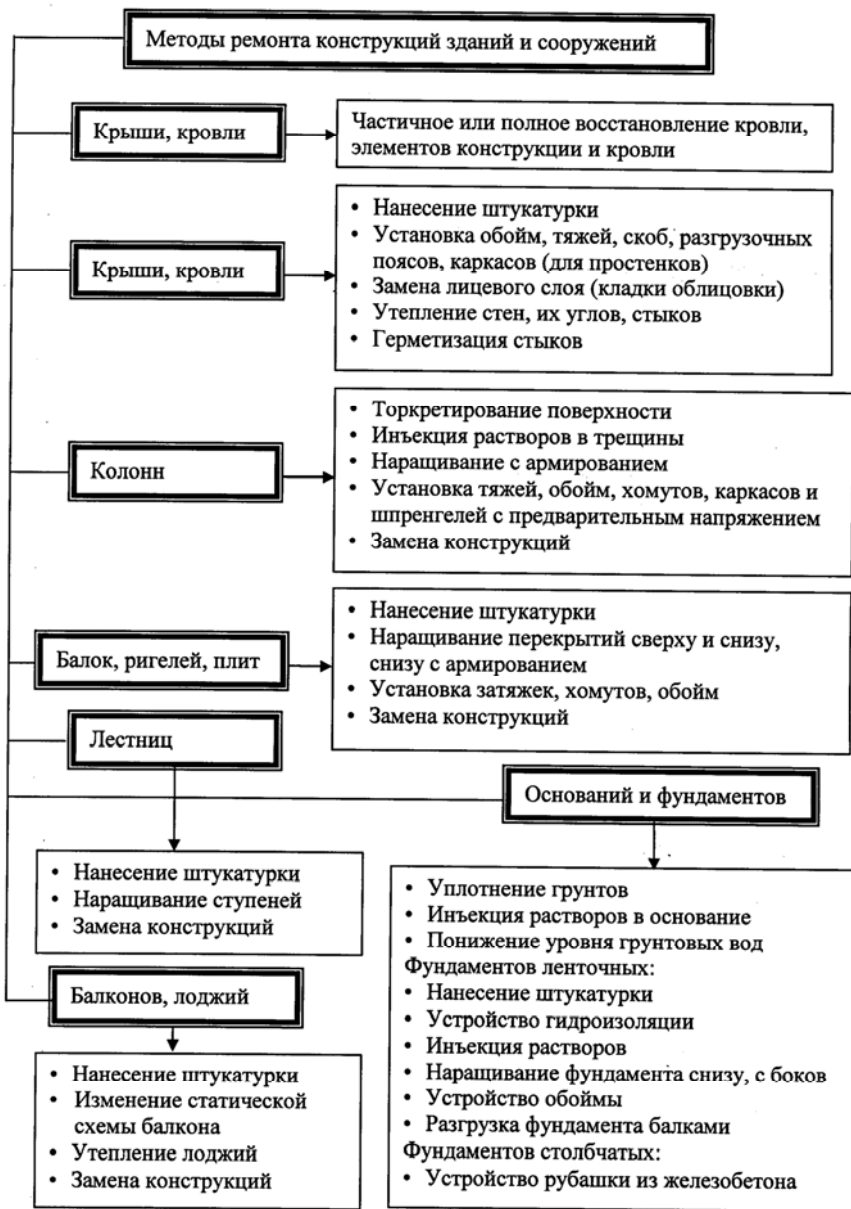
Рис. 3.9. Методы реконструкции сооружений
