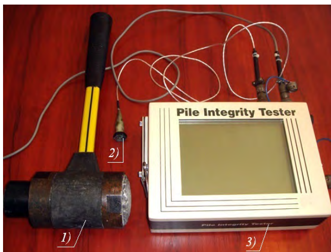
Рис. 4.11. Прибор для контроля сплошности свай PИТ-V: 1 – молоток с датчиком; 2 – акселерометр; 3 – блок сбора информации
