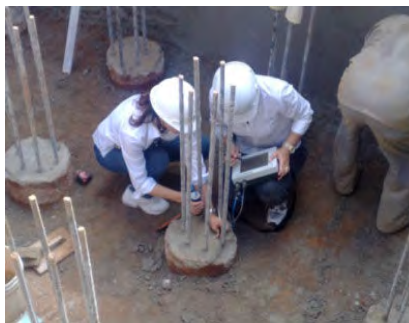
Рис. 4.16. Тестирование свай на строительной площадке
