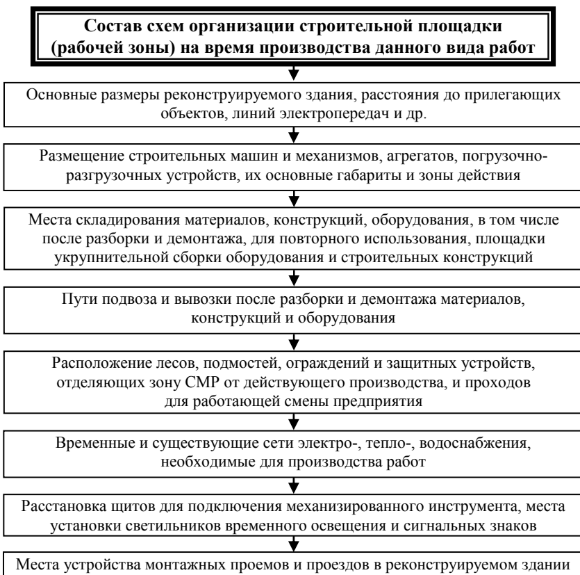
Рис. 2.4. Состав схем организации строительной площадки
