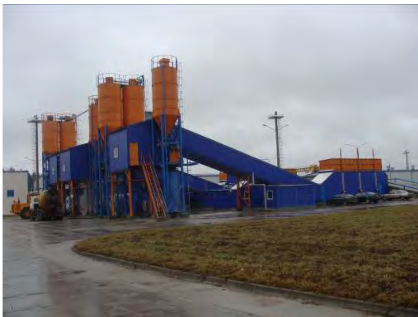
Рис. 6.12. Общий вид стационарных растворобетонных комплексов, разработанных для Объединённой пионерной производственной базы строительства АЭС в г.п. Островец Гродненской обл. (разработка БНТУ)
