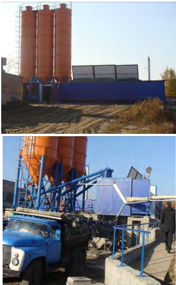
Рис. 6.14. Общий вид перебазируемого растворобетонного комплекса на производственной базе КУП «Брестский городской ремонтно-строительный трест» (разработка БНТУ)
