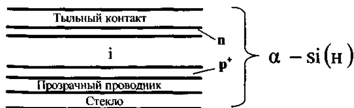
Рис. 1.30. Структура фотопреобразователя из аморфного кремния
