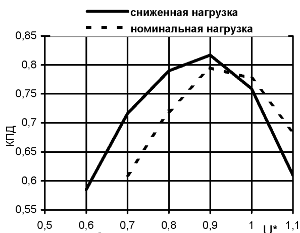
Рис.6.24. Зависимость КПД от величины подведенного напряжения
