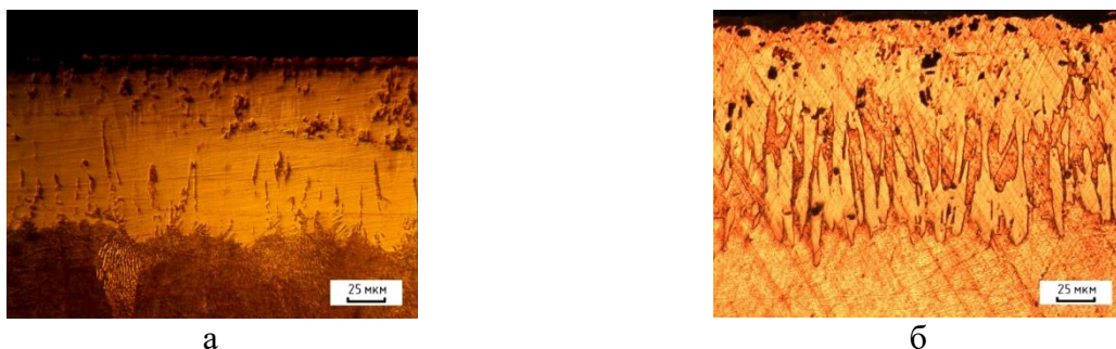
Рисунок 1 – Микроструктуры термодиффузионных однофазных боридных слоев: а – традиционный слой; б – диффузионный слой полученный после предварительного меднения
