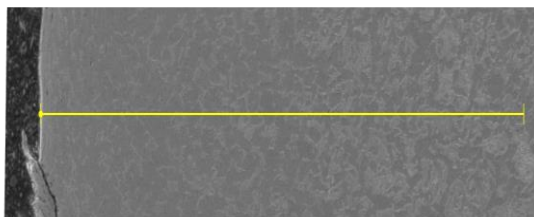
Рисунок 1. Структура стали после легирования частицами свинца в режиме сверхглубокого проникания и последующего газового азотирования, \times 10
