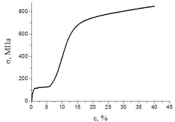
Рисунок 1 – Деформационная кривая TiNi сплава
