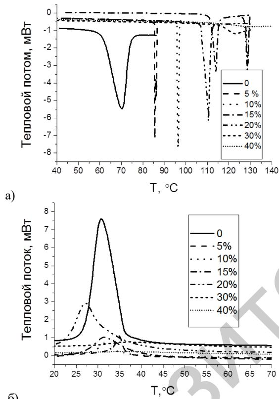
Рисунок 2 – Калориметрические зависимости никелида титана при нагреве (а) и охлаждении (б) после их предварительной деформации
