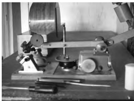
Рис. 3.3. Установка для распиливания сверхтвердых кристаллов с реализацией виброударного режима работы при помощи электромагнитной диафрагмы: а – схема; б – общий вид; 1 – станина; 2 – передняя пара стоек; 3 – задняя пара стоек; 4 – шпиндель; 5 – распиловочный диск; 6 – стрела; 7 – оправки; 8 – распиливаемый образец; 9 – регулировочный винт; 10 – электромагнитная диафрагма; 11 – упругая подушка; 12 – механизм, противодействующий самоотвинчиванию; 13 – электродвигатель привода распиловочного диска; 14 – регулируемый противовес
