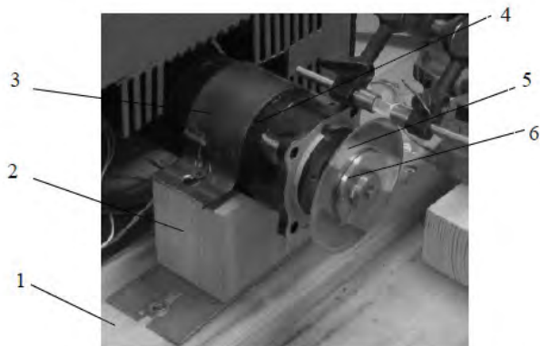
Рис. 4.6. Узел привода вращения распиловочного (отрезного) диска: 1 – основание секции; 2 – установочная призма; 3 – хомут; 4 – электродвигатель постоянного тока; 5 – отрезной диск; 6 – фланец
