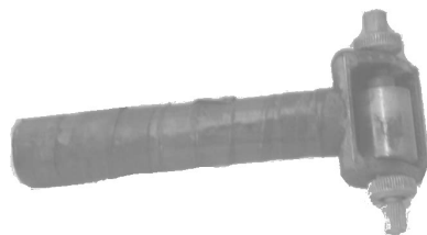
Рис. 3.15. Фотография приспособления для шаржирования торцевой поверхности распиловочного диска в процессе обработки
