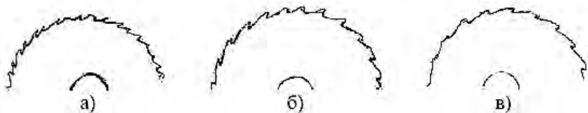
Рис. 4.38. Траектории движения точки, принадлежащей заготовке, на поверхности вращающегося диска ( n = 10 \text{ мин}^{-1} ) при различной частоте f возбуждения колебательной системы распиловочной секции за один оборот диска: а – f = 4 \text{ Гц} ; б – 2,8 \text{ Гц} , в – 3 - 2 \text{ Гц}
