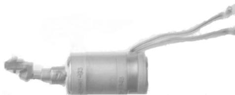
Рис. 3.4. Центробежный вибратор: а – общий вид; б – использованный электродвигатель с механизмом возбуждения вибрации
