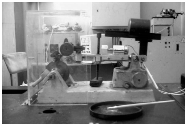
Рис. 3.5. Экспериментальная установка с центробежным вибратором: а – схема; б - фотография общего вида; 1 – обрабатываемая заготовка; 2 – стрела; 3 – противовес; 4 – распиловочный диск; 5 – регулировочный винт; 6 – упругая прокладка; 7 – вибратор
