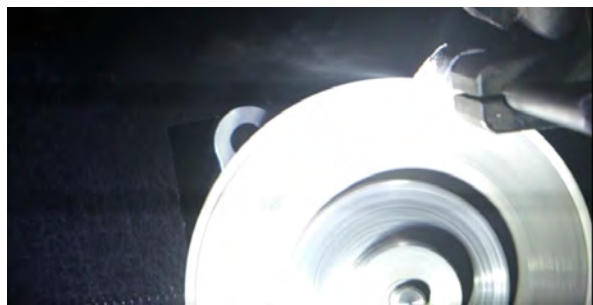
Рис. 4.48. Момент интенсивного выброса частиц разрушенного материала из зоны распиливания во время ударно-фрикционного взаимодействия стеклянного образца с диском
