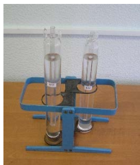
Рисунок 1 – Внешний вид ампулы тройной точки воды и вспомогательное оборудование
