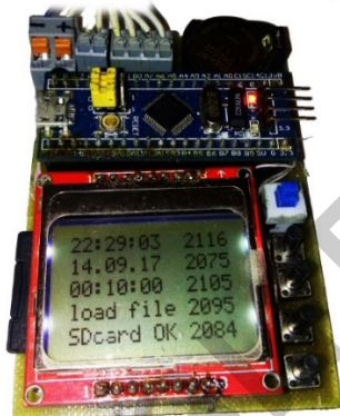
Рисунок 1 – Универсальный цифровой даталоггер-самописец
