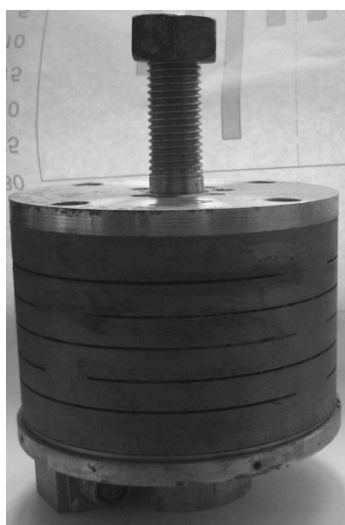
Рисунок 3 – Весоизмерительная опора (защитный кожух снят)
