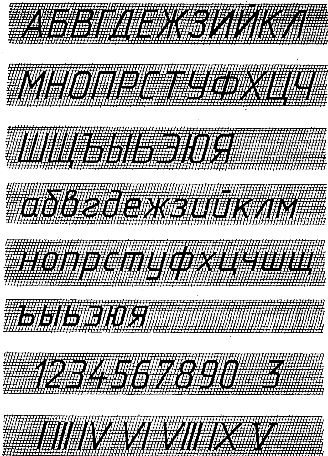
Рис. 1.7. Шрифт Б с наклоном 75° (кириллица)
