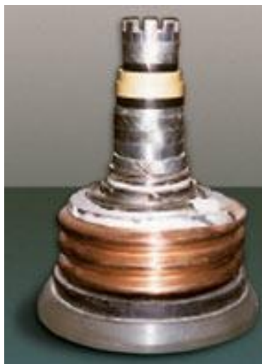
Рисунок 3. НТСП-кабель на 3 ГВА (разработка ВНИИКП).
