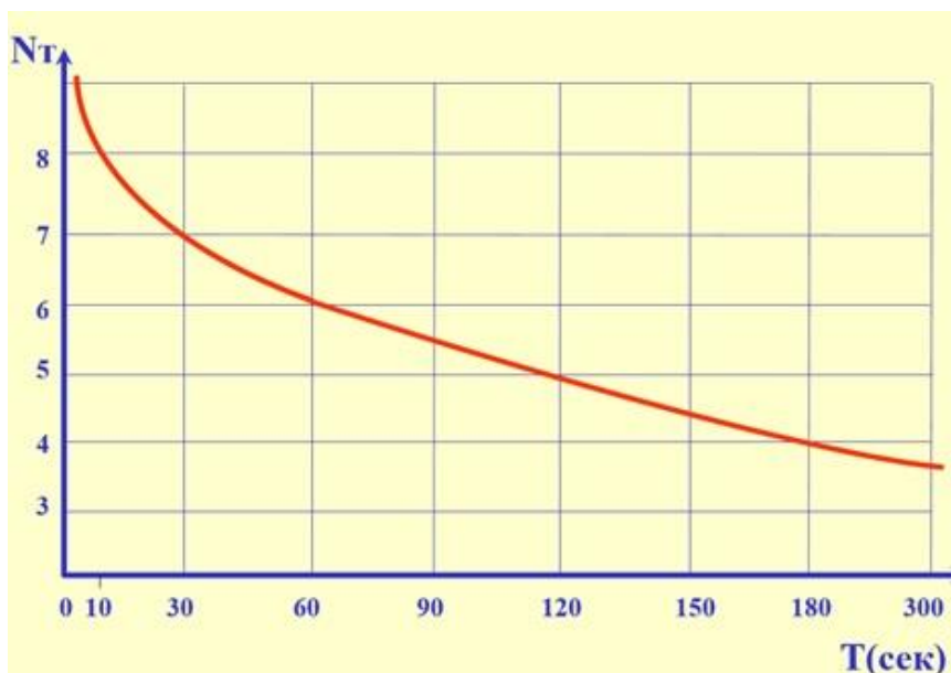
Рисунок 1. Остаточные тепловыделения РУ после срабатывания АЗ
