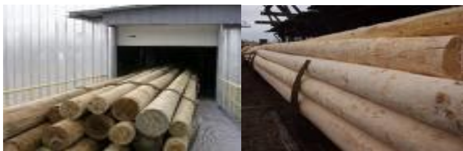
Рисунок 2. Бревна для изготовления деревянных опор.
