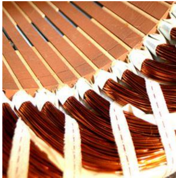
Рисунок 1. – Пример использования «НОМЕКС» в изоляции
