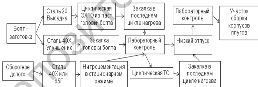
Рисунок 5 – Схема технологического процесса
