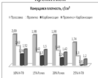
Рис. 3. Влияние состава и режимов обработки на кажущуюся плотность
