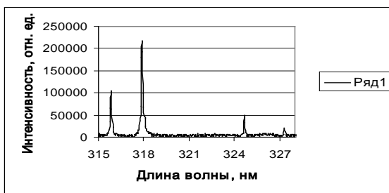
Рис. 3. Спектр образца томата при временном интервале между двоянными импульсами 8 мкс и энергии 50 мДж с количеством накоплений 100 точек
