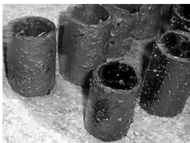
Рис. 1. Образцы после пиролиза: дальний ряд – без пропитки бакелитовой смолой, ближний – с пропиткой
