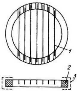
Рисунок 2 – Конструкция ВЧ сеточного электрода:
