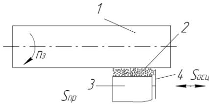
Рисунок 2 – Схема магнитно-абразивной обработки с наложением ультразвуковых колебаний:
