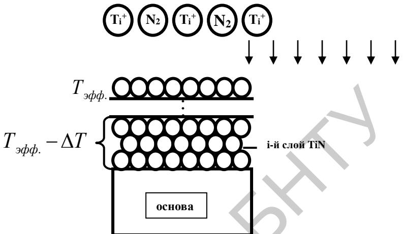
Рисунок 1 – Схема формирования мультислойного TiN покрытия
