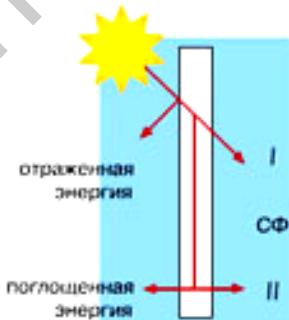
Рисунок 1 – Схема взаимодействия солнечного излучения со стеклом
