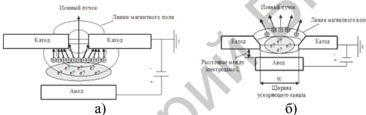
Рисунок 2 – Конструкции электродной системы ионного источника
