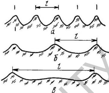
Рисунок 3 – Распределение съёма материала образца между пластинаами электрода при различных расстояниях между пластинами:
