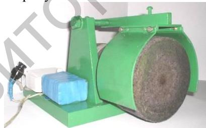
Рисунок 1 – Общий вид приспособления для определения износостойкости покрытий
