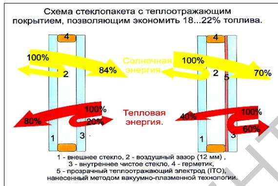
Рисунок 2 – Схема стеклопакета с теплоотражающим покрытием
