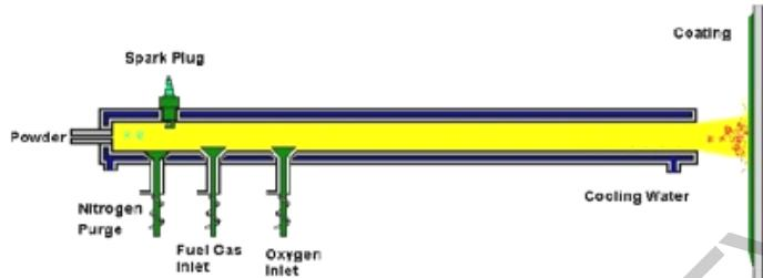
Рисунок 1 – Схема установки детонационного напыления
