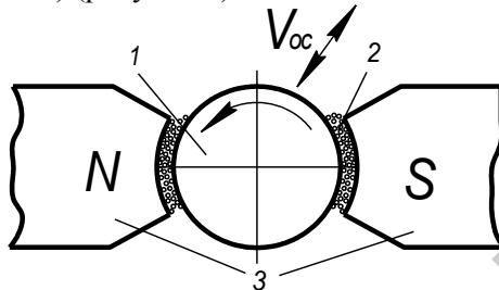
Рисунок 1 – Схема магнитно-абразивной обработки:
