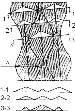
Рисунок 1 – Схема образования гребешков
