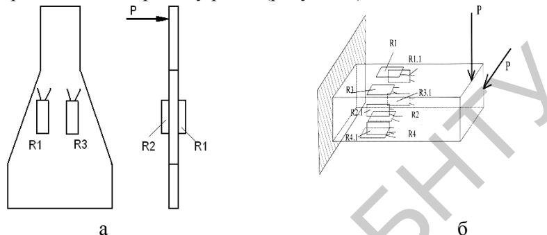
Рисунок 3 – Схема расположения тензорезисторов на балке равного сопротивления (а) и державке резца (б)
