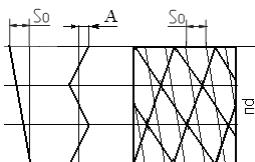
Рисунок 1 – Развёртка движения резца
