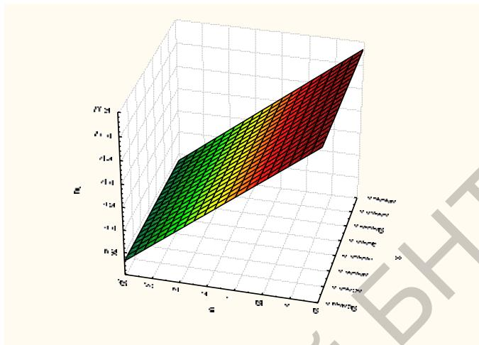
Рисунок 1 – Зависимость прочности от размера частиц SBA и соотношения объемов порошков
