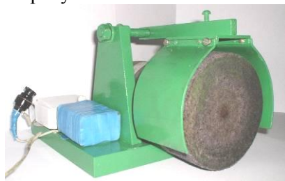
Рисунок 1 – Общий вид приспособления для определения износостойкости покрытий
