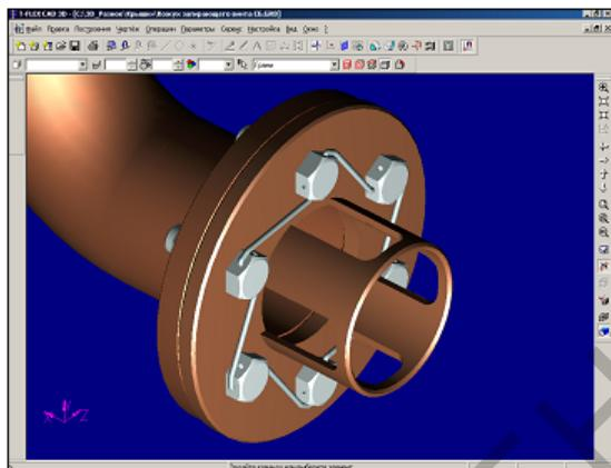
Рисунок 2 – Созданная модель детали в сборочной модели
