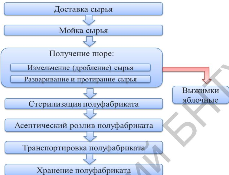
Рисунок 1 – Структурная схема производства яблочного пюре
