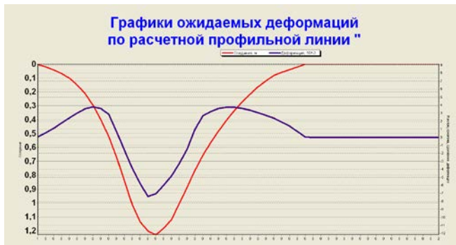
Рис. 2. Графики ожидаемых деформаций (красная линия – оседание, фиолетовая линия – горизонтальные деформации) Параметры системы разработки: - 3 калийный горизонт; - II-III сильвинитовый слой. - глубина разработки - 555м - вынимаемая мощность - 2,1м; - коэффициент извлечения – 1.
