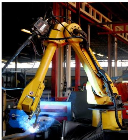
Рисунок 7 – Роботизированный сварочный пост
