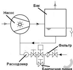
Рисунок 2 – Схема подключения рабочей жидкости с частичной рециркуляцией
