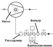
Рисунок 1 – Схема подключения рабочей жидкости без рециркуляции
