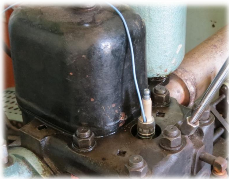
Рисунок 3 – Место установки пьезодатчика
