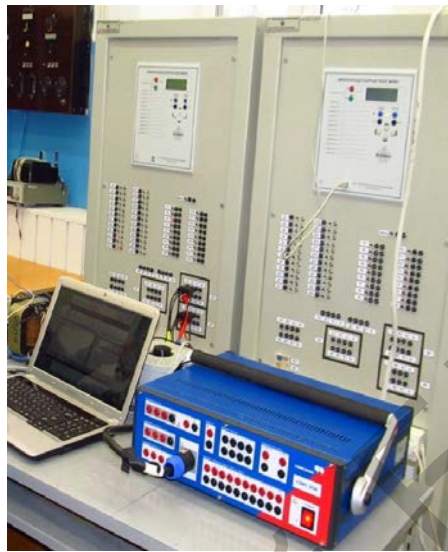
Рис. 7. Аппаратно-программный испытательный комплекс для проверки работоспособности цифрового реле МР 801
