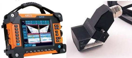
Цифровой ультразвуковой дефектоскоп SUPOR и фазированная решетка.
