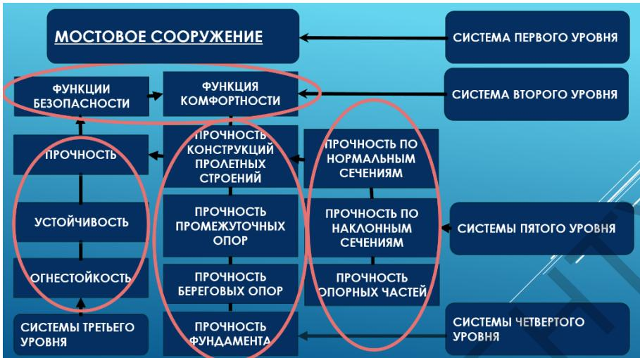
Рисунок 1 – Иерархия мостового сооружения как технической строительной системы
